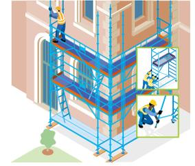
L'assemblage de l'échafaudage est réalisé selon la notice du fabricant par du personnel formé.
